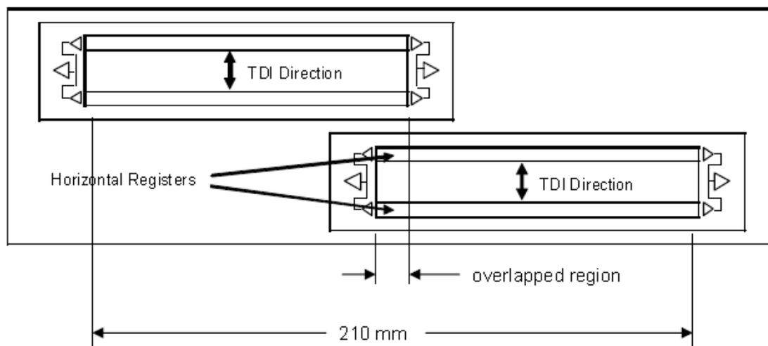
Fig. 2. BTDI Block diagram
